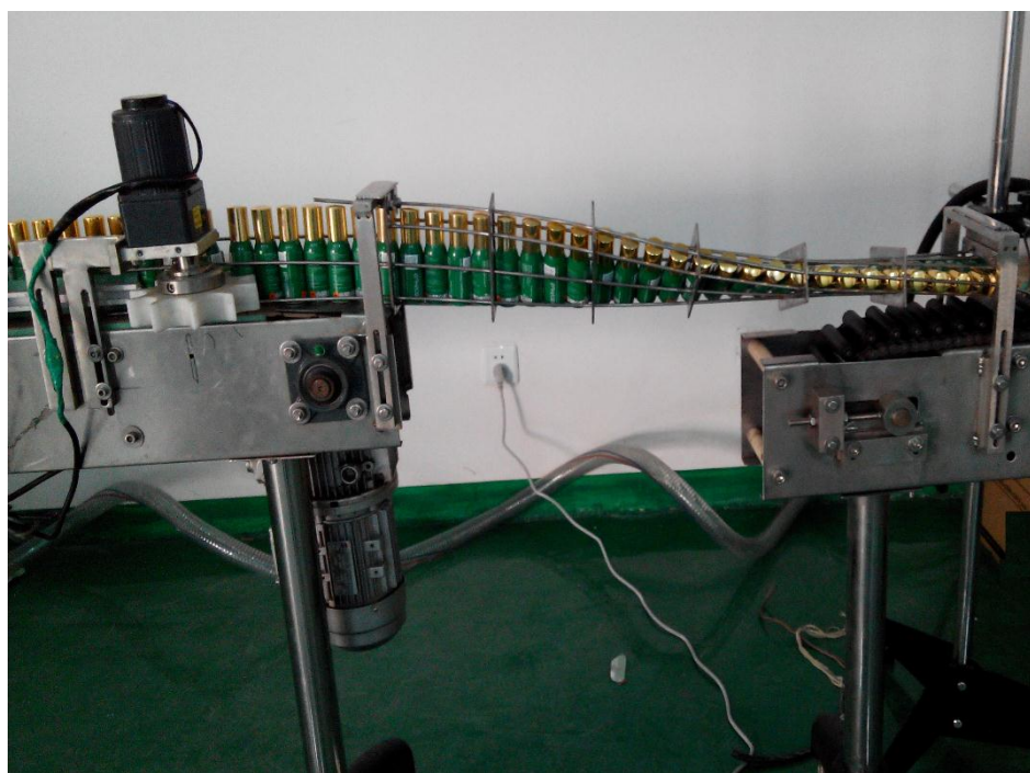
Рисунок 3 –Поточная линия по производству бактерицидных спреев
