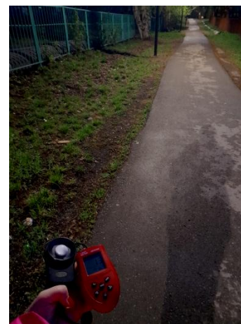
Рисунок 2 – Проведение эксперимента по замеру освещенности пешеходной зоны
