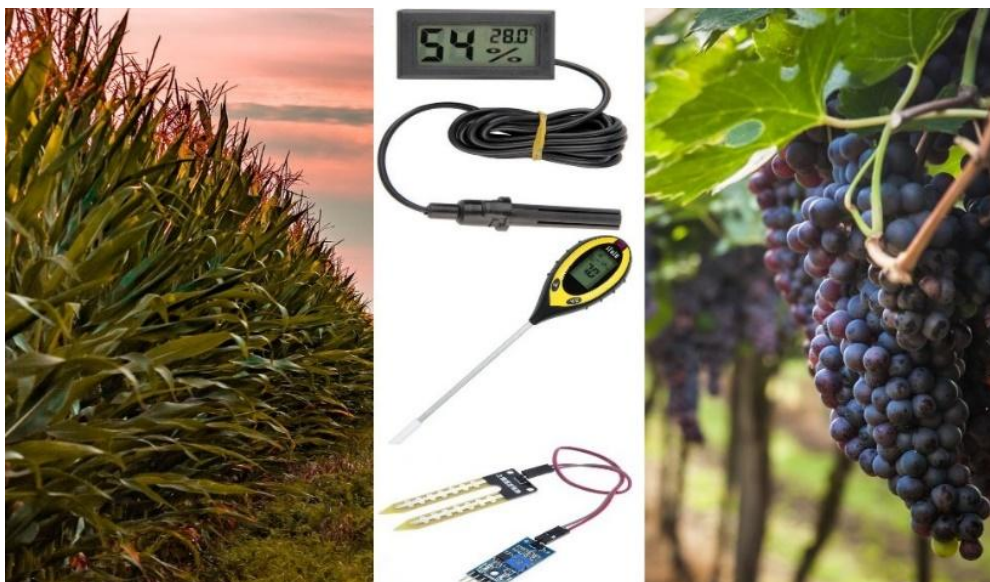
Рисунок 1 – Датчики систем капельного полива (датчики влажности, температуры почвы, содержания питательных веществ)
