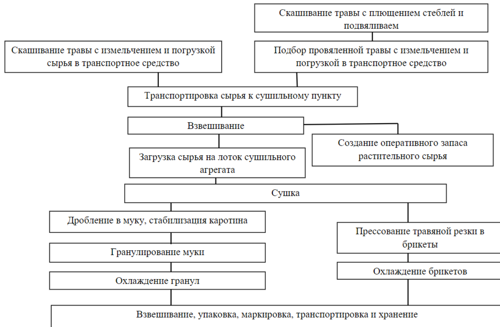
Рисунок 6 – Технологическая схема приготовления травяной муки
